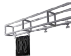
Шаг 2: Присоедините панели экрана к соединительным блокам для подвеса
