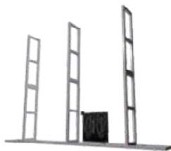
Шаг 2: Присоедините панели экрана к раме с помощью соединительных блоков
